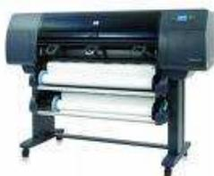
**Plotter.-** Conocido como trazador gráfico, es un dispositivo de impresión conectado a un ordenador, y diseñado específicamente para trazar gráficos vectoriales o dibujos lineales: planos, dibujos de piezas, etc. Efectúa con gran precisión impresiones gráficas que una impresora no podría obtener.
