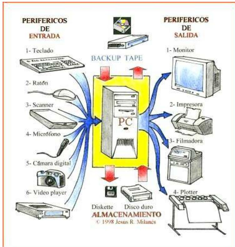
Como se puede observar en la gráfica, todos los demás componentes que integran una computadora son componentes periféricos. Los hay de entrada y de salida.
