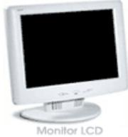
**Monitor.-** Es la pantalla en la cual puedes visualizar todo lo que trabajas en tu computadora (imagen y texto). Se asemeja a un televisor y básicamente los hay de dos tipos: El CRT (Cathode Ray Tube), basado en un tubo de rayos catódicos como el de los televisores, y el LCD (Liquid Crystal Display); el cual es una pantalla plana de cristal líquido, representando lo último en tecnología.
